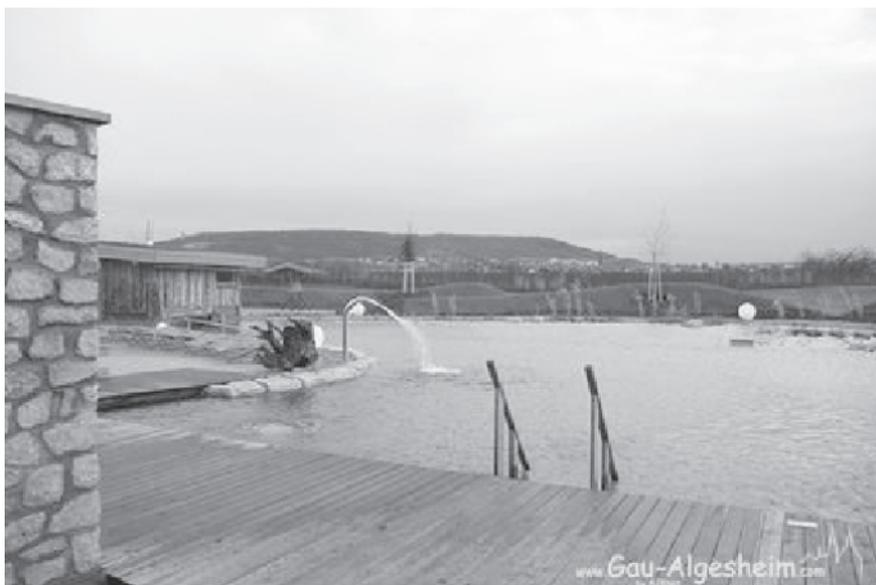
Der naturnah gestaltete Badebereich ist künstlich angelegt. Er ruht in einer Betonwanne, die mit einer speziellen Badeteichfolie ausgekleidet ist. Der Badeteich, das grüne Herz der Sauna-Anlage, reinigt sich selbst in einer Regenerationszone, einem Filterbeet mit Wasserpflanzen, die gefilterte Stoffe aufnehmen und verarbeiten.
