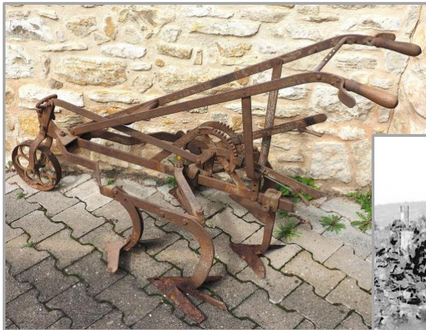
Grubber, in der Breite verstellbar
